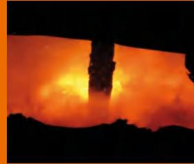
当今用钢领域客户对钢种的化学成分，机械性能以及低杂质等要求愈发严格，尤其是硫成分的存在易导致钢材脆化及颗粒状裂纹进而影响钢材的延展性能及韧性等机械性能，因此，EAF电弧炉出钢后的钢液在进入连铸之前，需进行精炼脱硫处理，使钢液的硫含量达到目标值范围，进而提升钢品质。
